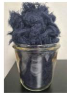
Matière obtenue après transformation des chutes de coupe du tissu principal. La technologie innovante utilisée permet d'obtenir des fibres de longueurs supérieures à celles obtenues par des procédés conventionnels du recyclage. Cette approche permet une grande panoplie de solutions.
